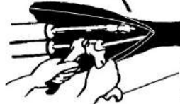
гайковий ключ з обмеженням по обертовому моменту
