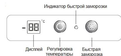
Кнопка регулировки температуры расположена на панели регулировки температуры. С ее помощью можно менять температуру в морозильной камере. Одно нажатие на кнопку изменяет температуру на один градус. Температуру можно регулировать в диапазоне от -16°C до -24°C.
