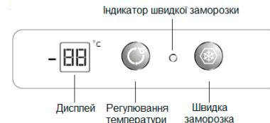
Кнопка регулювання температури розташована на панелі регулювання температури. З її допомогою можна змінювати температуру в морозильній камері. Одне натискання на кнопку змінює температуру на один градус. Температуру можна регулювати в діапазоні від -16°C до -24°C.
