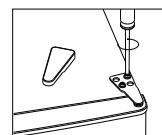
3 Снимите крышку верхнего левого винта.
