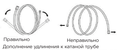
Распрямление соединительной трубы
