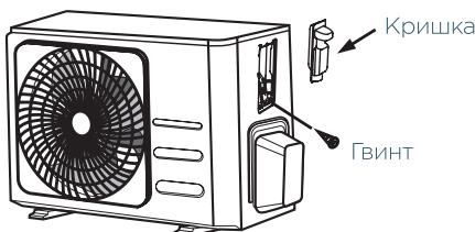
**ПРИМІТКА:** Якщо кабельний затискач відповідає зображенням, виберіть відповідний наскрізний отвір відповідно до діаметра провода.
