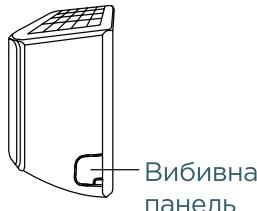
3. Якщо наявні з'єднувальні трубопроводи вже вбудовані в стіну, перейдіть безпосередньо до кроку **Під'єднання зливного шланга**. У разі відсутності вбудованих трубопроводів підключіть трубопроводи холодаагенту внутрішнього блоку до з'єднувальних трубопроводів, які з'єднають внутрішній і зовнішній блоки. Докладні інструкції див. у розділі Підключення трубопроводів для холодаагенту цього посібника.
