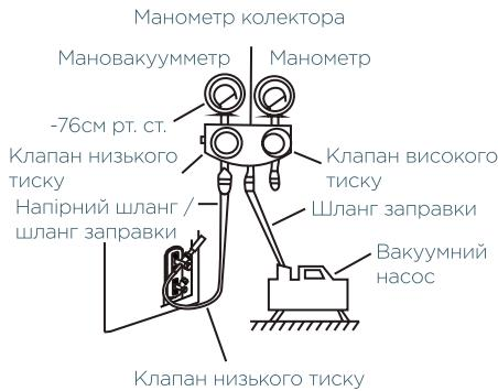
6. Закрійте сторону манометра колектора низького тиску та вимкніть вакуумний насос.
