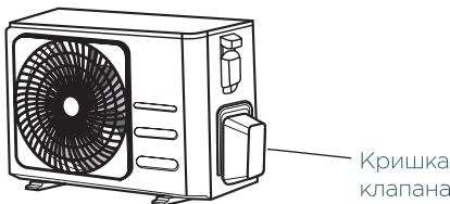
5. Міцно стискаючи корпус клапана, використовуйте динамометричний ключ, щоб затягнути конусну гайку відповідно до значень крутного моменту.
