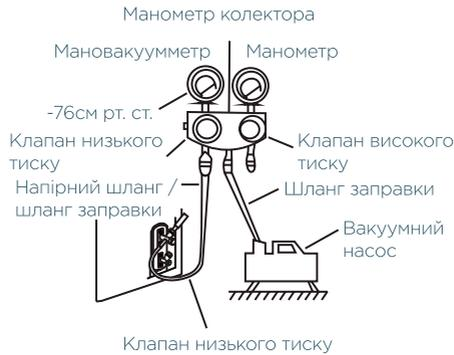
6. Закрийте сторону манометра колектора низького тиску та вимкніть вакуумний насос.
